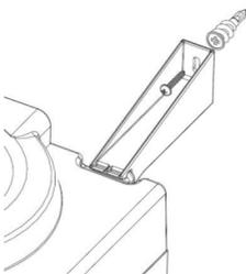
Nota: Retire el tornillo para liberar el dispensador cuando necesite limpiarlo o colocarlo en otro lugar.
